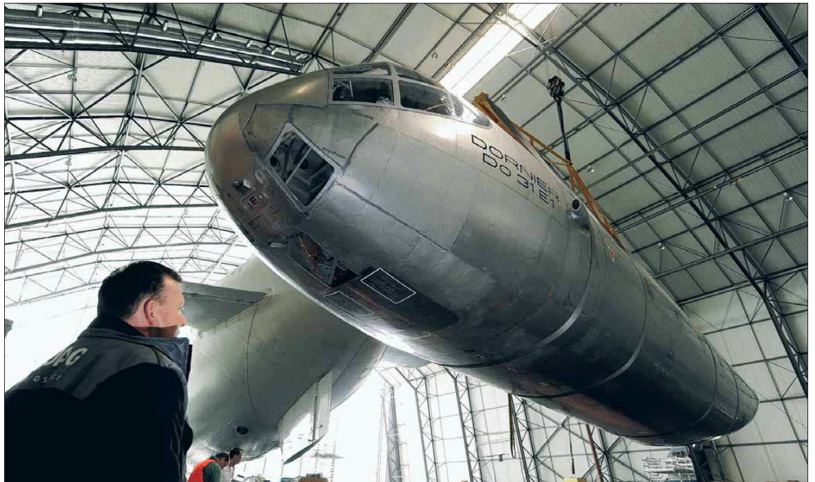
Die Dimensionen der Do 31 sind gewaltig: Der Flieger ist 20,9 Meter lang, 8,5 Meter hoch, die Spannweite beträgt 18,1 Meter, die Flügelfläche 57 Quadratmeter.
